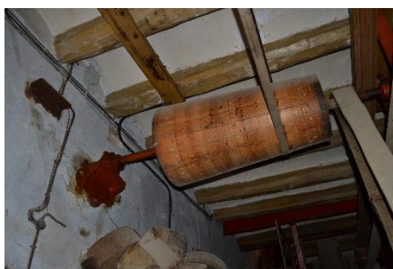
Rodes que transmeten l'energia de l'aigua a les màquines.
