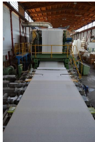
Màquina de paper. Part humida
