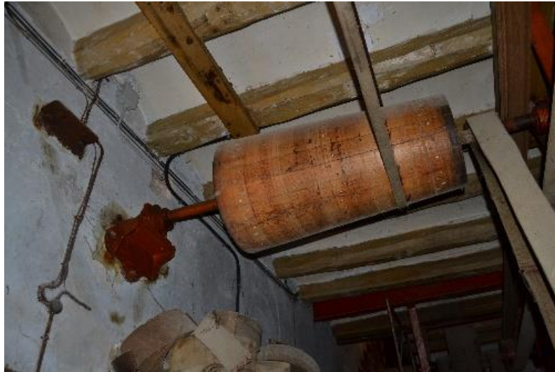
Rodes i mecanismes de transmissió a la planta baixa del molí 149
